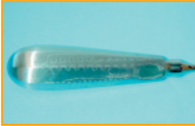
Manchas en el instrumental Causa: Secado del agua con alto nivel de salinidad
