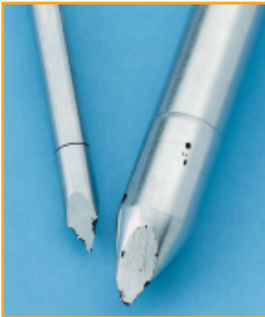
Corrosión por picaduras en un Trocar Causa: Alto nivel de cloro en el agua
