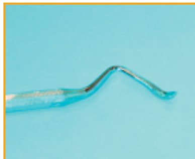
Instrumental con restos de gel corrosivo
