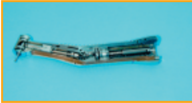
Diseño interno de la pieza de mano y acodada
