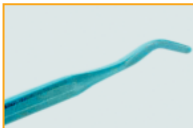
Espátula de llenado corroída Causa: Corrosión a través de limpiadores ácidos para cemento
