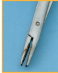
Corrosion en fissures
