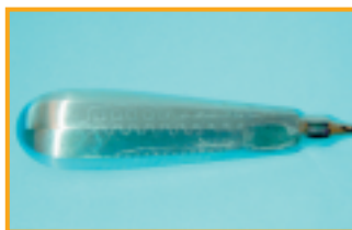
Instruments tachés Cause : séchage d'eau
