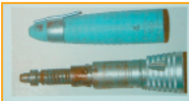
Restos de sangre en el mango Causa: Limpieza insuficiente
