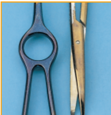
Decoloración del instrumental Causa: Lavado insuficiente
