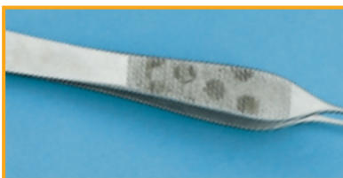
Manchas en pinzas Causa: Calidad de vapor insuficiente
