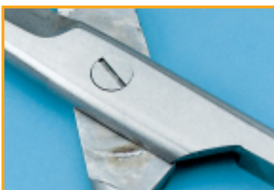
Corrosión en las tijeras Causa de la corrosión: Falta de mantenimiento con aceite
