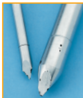
Corrosión por picaduras en un Trocar Causa: Alto nivel de cloro en el agua
