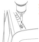
USE CARE WHEN BREAKING THROUGH. A DRILL STOP IS RECOMMENDED
