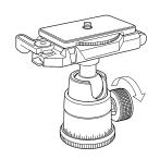
雲台のボール固定ツマミをゆるめると、カメラ台部 とベースプレートが回転します。
