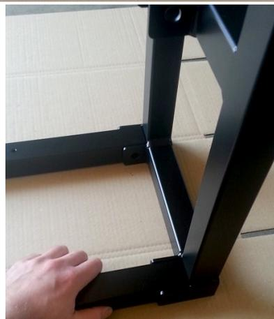
4. Per tutti e quattro gli angoli del telaio, inserire una vite (D) munita di rondella (E) attraverso i fori di passaggio;
