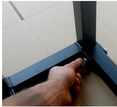
6. applicare il traverso inferiore (C) nell'apposito alloggiamento centrale (applicando sempre una certa pressione) ed inserire alle due estremità vite e rondella (D)+(E);
