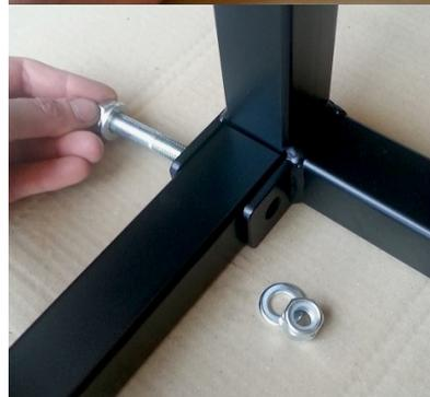
5. all'uscita di ogni vite applicare una nuova rondella (E) e avvitare un dado (F) manualmente senza serrarlo;
