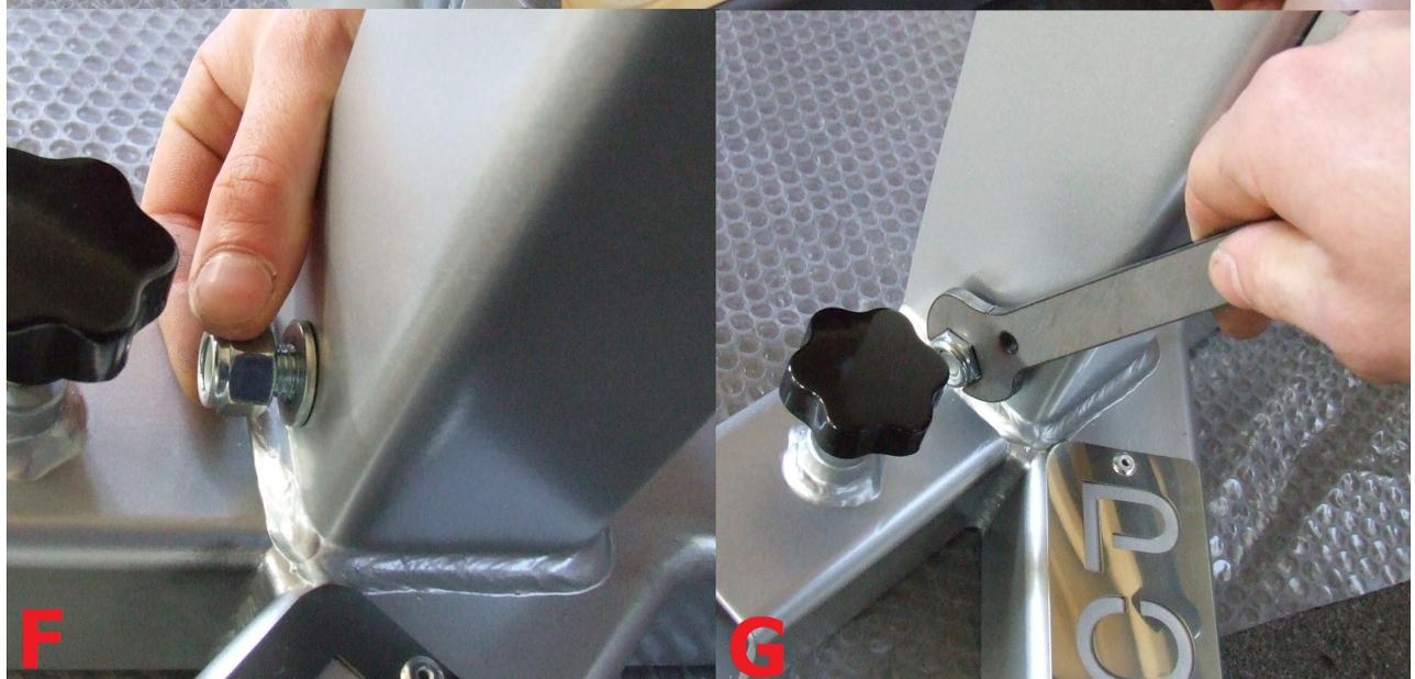
Ripetere in maniera speculare sul lato sinistro del rack, assicurandosi di montare la colonna con la leva contrassegnata 'L'.
