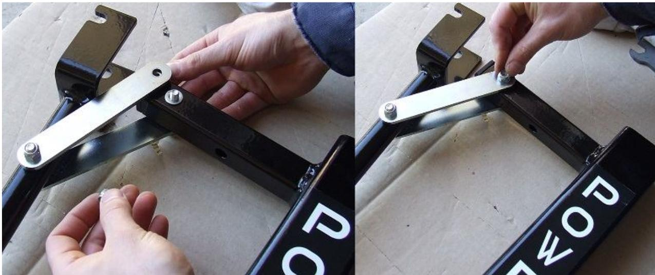
Per procedere al corretto serraggio del dado, usare le chiavi in dotazione sulla misura 13 e avvitare fino a serraggio completo dopodiché svitare il dado di 1/3 - 1/2 giro a seconda del gioco desiderato. La forcella deve risultare libera di muoversi senza ballare eccessivamente.
