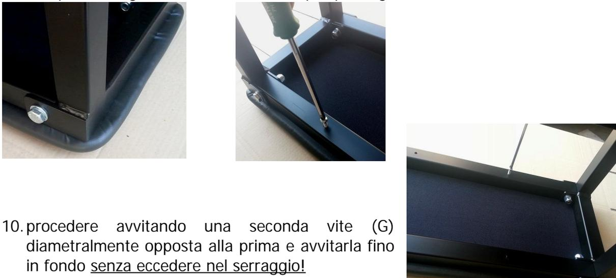
10. procedere avvitando una seconda vite (G) diametralmente opposta alla prima e avvitarla fino in fondo senza eccedere nel serraggio!
