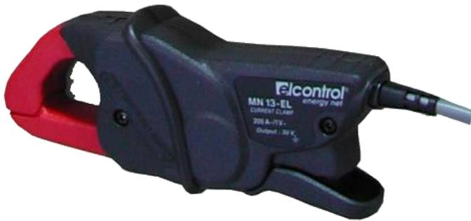
La pinza amperometrica MN13 è utilizzabile su tutti gli analizzatori della famiglia **NanoVIP®** per la misura delle correnti alternate fino a 200 A; è dotata di un sistema di **riconoscimento automatico** da parte dell'analizzatore che rende molto semplice il suo settaggio.
