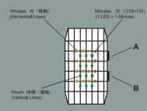
Key A Time Telling Key B Set function キーA 時間表示 キーB 時間設定
