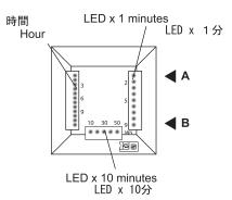
Key A - 2 o'clock position (Time Telling) Key B - 4 o'clock position (Set function) キーA 2時の位置(時間表示) 4時の位置(時間設定)
