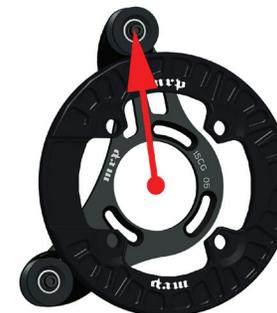
POSITION THE BOOMERANG SO THAT THE TOP ROLLER IS AT THE 11:30 POSITION IF YOU ARE LOOKING STRAIGHT-ON AT THE CHAINRING. TIGHTEN THE ISCG SCREWS ENOUGH TO HOLD THE BOOMERANG IN POSITION, BUT LOOSE ENOUGH THAT YOU CAN ROTATE IT TO THE PROPER POSITION IN THE STEPS BELOW.
