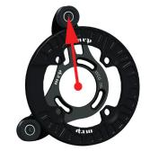
POSITION THE BOOMERANG SO THAT THE TOP ROLLER IS AT THE 11:30 POSITION IF YOU ARE LOOKING STRAIGHT-ON AT THE CHAINRING. TIGHTEN THE ISCG SCREWS ENOUGH TO HOLD THE BOOMERANG IN POSITION, BUT LOOSE ENOUGH THAT YOU CAN ROTATE IT TO THE PROPER POSITION IN THE STEPS BELOW.
