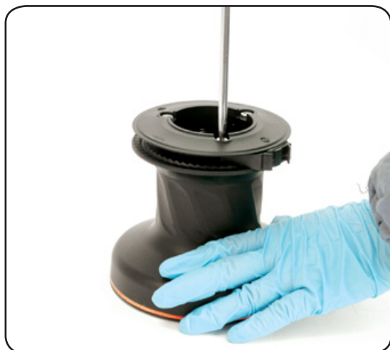
I. Unscrew the 3 screws n°19 ( \approx 4\text{Nm}/35\text{ in-lb} )
