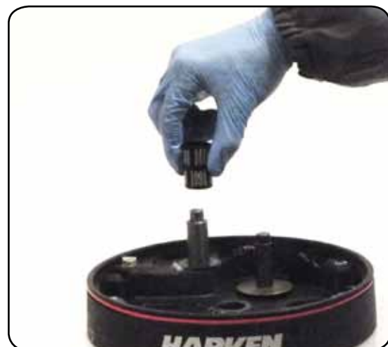
18. Remove roller bearings n°15
