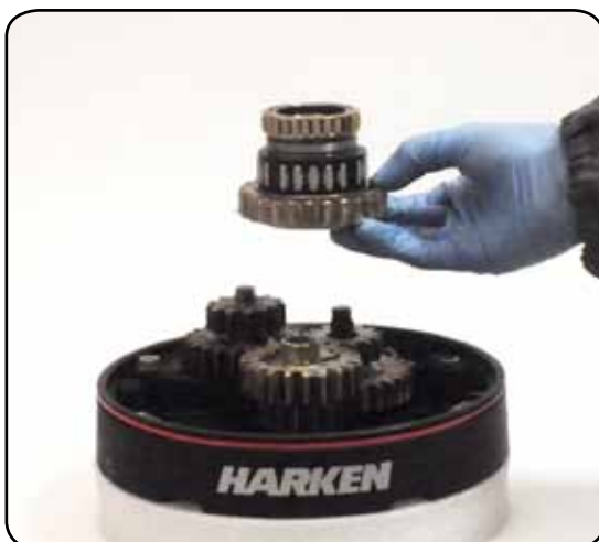
11. Remove the gear n°31, pawls carrier n°33, the bearings n°34 and 36 and the pin n°35
