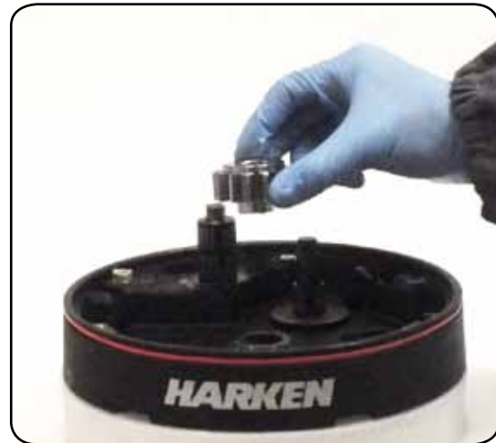
16. Remove the gear n°2
