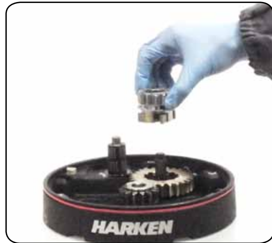
14. Remove the pawl carrier n°11
