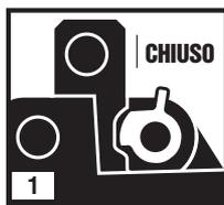
1. Leva dello strozzatore in posizione chiusa (in alto). Il bozzello è bloccato in posizione frontale o laterale.
