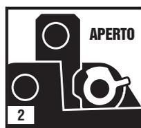
2. Leva dello strozzatore in posizione aperta (in basso). Il bozzello ruota liberamente.
