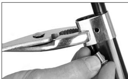
Placez la butée supérieure sur le profil en orientant la gorge vers l'arrière, avec le grand trou à tribord. Serrez la butée sur le profil à l'aide de pinces. Versez un peu de Loctite® bleu dans la partie femelle de la vis canon. Fixez la butée au profil avec l'ensemble vis canon à l'aide d'un tournevis cruciforme.
