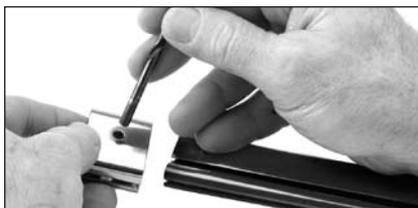
**Conseil pratique :** Des trous pratiqués dans la butée supérieure sont de diamètres différents. Vérifiez que le foret Ø 5 mm (3/16") passe dans le trou visible de la butée supérieure et que le côté du profil portant les gorges latérales est orienté vers le haut.
