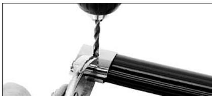
Resserrez la butée sur le profil à l'aide de pinces. En maintenant le foret vertical, percez un trou Ø 5 mm (3/16") dans la face supérieure du profil d'étai creux. Ôtez la butée et terminez le perçage. Vérifiez que la butée et l'ensemble vis canon se montent sans difficulté sur le profil. Ajustez le perçage si nécessaire.
