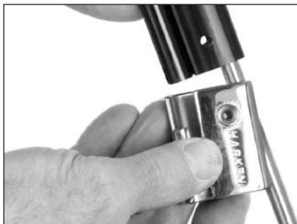
Insérez l'endrailleur sur l'étau et le profil et poussez-le fermement vers le haut.
