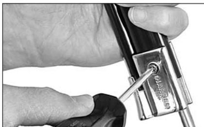
Enduisez les vis de Loctite® bleu avant de les serrer. Vérifiez l'alignement des trous de l'endrailleur et du profil si la vis ne mord pas dans le taraudage.
