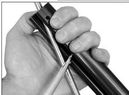
Ébrasez la gorge du profil avec un tournevis et emboîtez-le sur l'étai. Dès que le haut du profil recouvre l'étai sur une longueur suffisante, interrompez l'opération pour fixer la butée supérieure.
