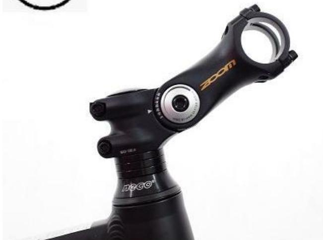
**Etape 2:** Desserrer le boulon ci-dessous (dans le cercle rouge) à l'aide d'une clé allen, puis ajuster la hauteur de la potence du guidon à la position souhaitée.
