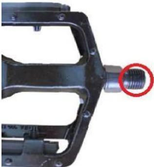
La pédale de droite (1) est filetée de manière à être serrée en tournant dans le sens des aiguilles d'une montre. Enfiler la pédale droite avec précaution sur la manivelle du côté droit du vélo, lentement et à la main. Ne croisez pas les fils et n'endommagez pas les filetages, et veillez à serrer la pédale avec la clé fournie.
