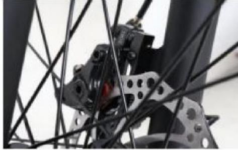
Placez complètement l'axe du levier de débloqué rapide dans l'axe de la fourche (et le disque de frein dans l'étrier) et tendez le levier en tournant l'écrou à ailettes, comme indiqué ci-dessous.
