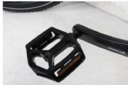
La pédale droite doit être du même côté que la chaîne
