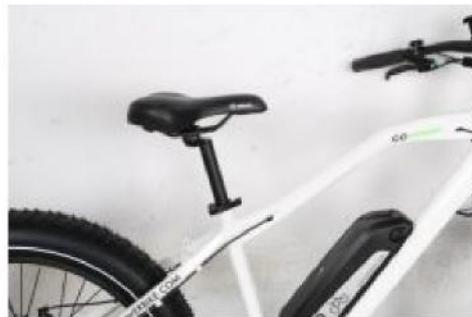
Si nécessaire, utilisez l'écrou à ailettes pour ajouter de la tension à la pince afin qu'il y ait plus de résistance lorsque le levier est aligné avec le boulon de serrage, mais ne serrez pas trop fort. Fermez le levier à déblocage rapide pour fixer la tige de selle et vérifiez qu'il ne se déplace.
