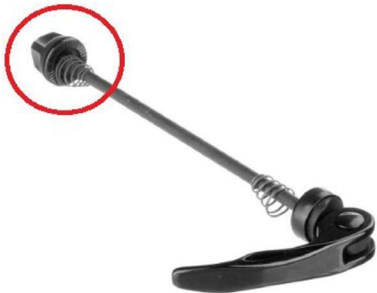
**Installez la broche dans l'axe de la roue avant, du côté du frein.** Réinstallez le ressort conique de manière à ce qu'il pointe vers le moyeu de la roue, puis vissez l'écrou à ailettes sur la broche de quelques tours seulement, en laissant de la place pour les pattes de fourche. Assurez-vous que le levier est ouvert et abaissez soigneusement la fourche sur l'axe et l'étrier de frein comme indiqué ci-dessous.
