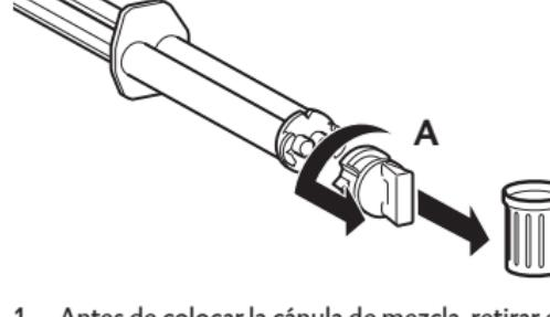
1. Antes de colocar la cánula de mezcla, retirar el capuchón de cierre [A] o la cánula de mezcla usada girando 90° en sentido antihorario y desecharlo.
