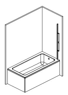
REPOSITION THE WALL PROFILE WHERE MARKED.
