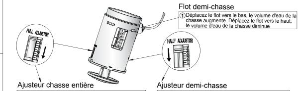
Déplacez l'ajusteur vers le bas, le volume d'eau de la chasse augmente. Déplacez le flot vers le haut, le volume d'eau de la chasse diminue.
