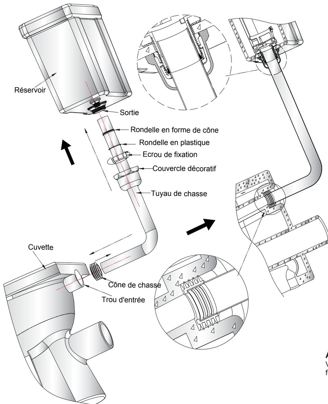
Déterminez l'emplacement exacte de la cuvette et du réservoir, ensuite coupez le tuyau de chasse en conséquence si nécessaire. Rentez le tuyau dans le réservoir dans l'ordre indiqué sur le diagramme. Ensuite insérez le cône de chasse dans la cuvette, suivi par le tuyau de chasse comme indiqué sur le diagramme
