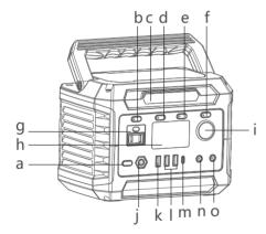
a. Power d. USB switch g. AC output j. DC input m. Type-c output b. AC switch e. LED switch
