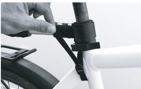
Placez la bande Velcro du Bike-Connector à la hauteur souhaitée autour de la tige de selle. Passez la bande Velcro dans l'œillet du connecteur de vélo, serrez-la de manière à ce que le connecteur de vélo ne puisse plus se tordre et fermez la bande Velcro. Fixez le connecteur de vélo en hauteur à l'aide de la sangle de tension en la fixant vers le bas autour d'un élément approprié du cadre du vélo.
