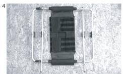
Führe zunächst die seitlichen Enden eines Radrahmens in die Verbindungsrohre im Trunk. Schließe die Snap-Locks an einer gewünschten Lochposition. Die Snap-Locks befinden sich dann in der richtigen Position zum korrekten Schließen, wenn genau ein halbes Loch sichtbar ist. Es ist am besten, die Snap-Locks bis zur Befestigung der Deichsel geöffnet zu lassen, da der Rahmen dadurch beweglicher bleibt und sich die Rohre leichter aufstecken lassen. Befestige den zweiten Radrahmen auf die gleiche Weise.
