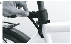
Lege das Klettband des Bike-Connectors an der gewünschten Höhe um die Sattelstütze. Fädle das Klettband durch die Öse des Bike-Connectors, spanne so stark vor, dass der Bike Connector nicht mehr verrutschen kann und schließe das Klettband. Fixiere den Bike-Connector mithilfe des Spanngurtes in der Höhe, indem Du ihn um ein geeignetes Fahrradrahmenbauteil nach unten befestigst.
