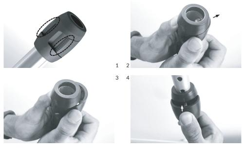
Den Clip des Snap-Locks an den Griffflächen mit je einem Finger umfassen. Drücke mit beiden Daumen weg vom Rohr senkrecht zur Rohrachse, um den Clip zu öffnen. Zum Schließen, von oben leichten Druck auf den Clip ausüben und einrasten lassen. !!! Beim Zusammensetzen und Zerlegen des Anhängers besteht an den beweglichen Teilen und den Snap-Locks Klemmgefahr für Finger und Hände !!!
