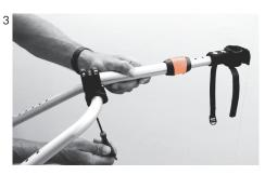
Der Bikeconnector ist an der Deichselverlängerung vormontiert. Achte beim Anbringen an der Sattelstütze darauf, dass er in Abhängigkeit seiner späteren Position waagerecht zur Straße ausgerichtet ist. Die Länge des Bike-Connectors sollte so eingestellt werden, dass die Deichsel nicht am Fahrrad schleift. Ziehe alle Schrauben am Bike-Connector so fest an, dass er sich nicht mehr verdrehen kann (Anzugsmoment 12 Nm)
