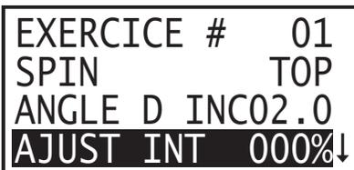
Avec la fonction **AJUST INT**, on peut augmenter ou diminuer le temps d'attente entre chaque balle. La valeur peut être réglée entre -100% jusqu'à +900% par étapes de 10%. Comme le **INTERVAL** est réglé en pourcentage, des exercices avec un temps d'attente différent peuvent se dérouler correctement à l'intérieur d'un même exercice. Les joueurs qui sont capables d'évoluer sur plusieurs niveaux, peuvent choisir le même exercice, sans réécrire à nouveau l'exercice.
