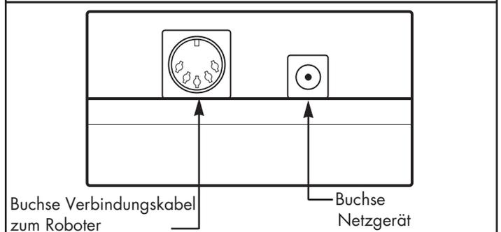
**Abbildung 2B** Steuergerät für Modell 540
