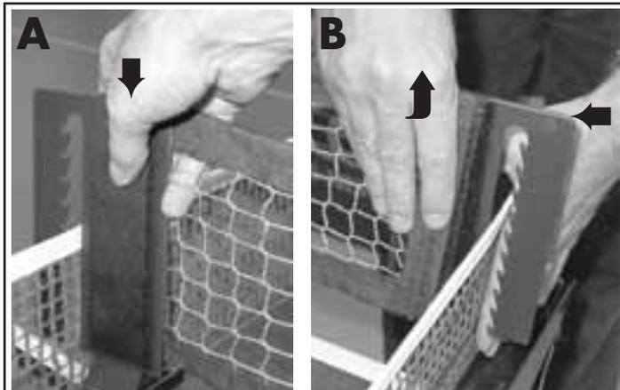
**Abbildung 20** MONTAGE UND DEMONTAGE DES SEITENNETZES (NUR 2040)
