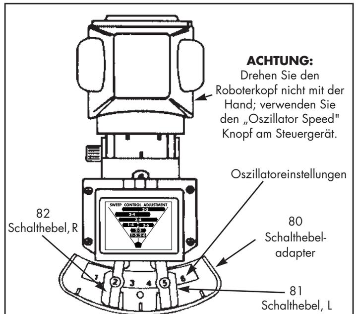
**Abbildung 9** SCHALTHEBEL DES OSZILLATORS VORDERANSICHT (NUR 1040/2040)
