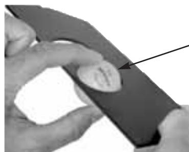
Drehen Sie den Ball in der Ballöffnung zur Überprüfung der Rundheit. Ball sollte in jeder Position leicht drehbar sein.
