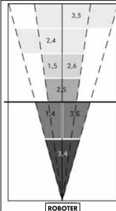
**Abbildung 10A** SCHWENKBEREICH DES OSZILLATORS BEI DEN VERSCHIEDENEN POSITIONEN, WOBEI DER ROBOTER IN DER MITTE DES TISCHES STEHT (NUR 1040/2040).
