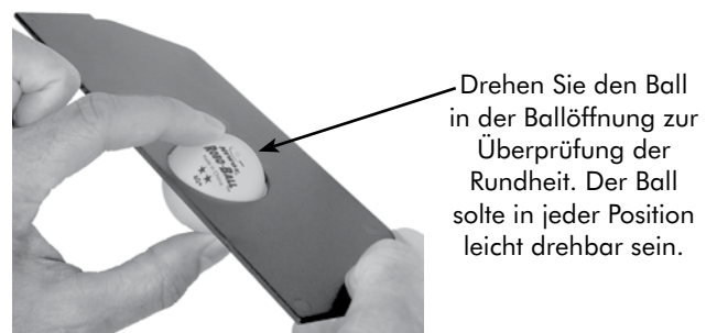
ABBILDUNG 11 ÜBERPRÜFUNG DER BALLGRÖSSE MIT BALLDAMM (NUR 2055)
