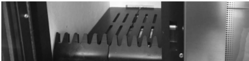
Reinigen Sie den Feuerraum vor der Inbetriebnahme mittels des mitgelieferten Aschekratzers.
