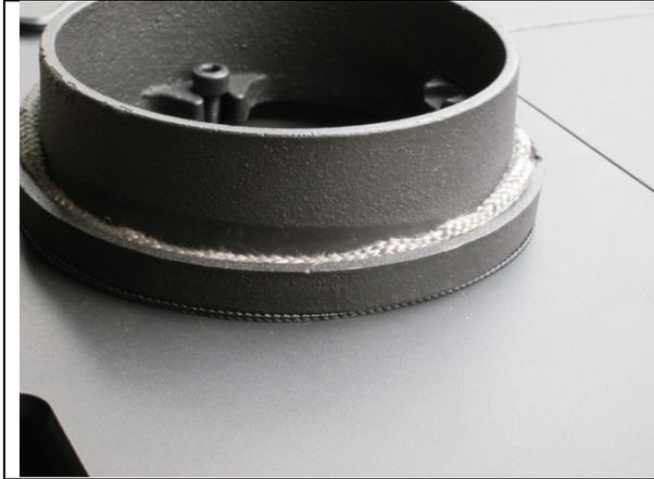
Zum Schluß die Runddichtung in den Falz einlegen.
