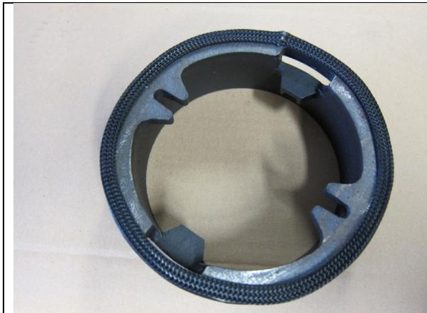
Schmale Dichtung auf die Unterseite des Stutzens entlang des den Rand kleben.
