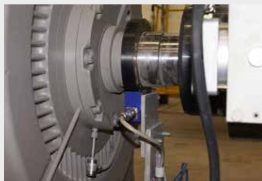
Nachrüstung ohne Anlagendemontage durch geteiltes Polrad / Retrofit without removal of installation through split pulse wheel
