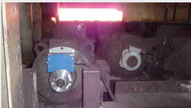
Rollgangsmotoren sind extremen Schock- und Vibrationsbelastungen ausgesetzt / Roller table motors are exposed to high shock and vibration loads
