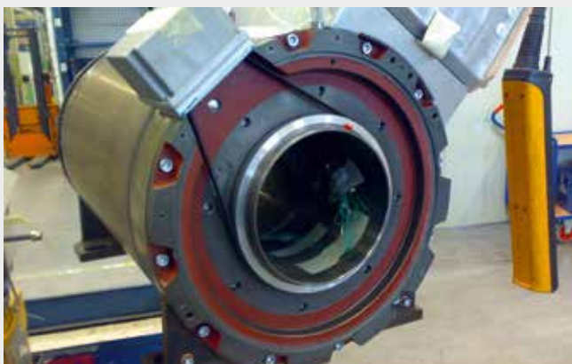
Vorher: externer Drehgeber mit Zahnriemen; Signalprobleme durch Riemen-Schwingungen / Before: external encoder with gear belt; signal problems through gear belt vibration
