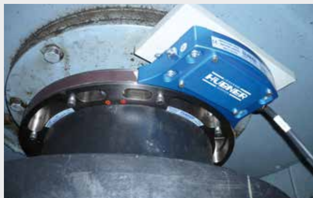
Realisierung mit geteiltem Polrad ohne Anlagendemontage/ Realization with split pulse wheel without removal of installation
