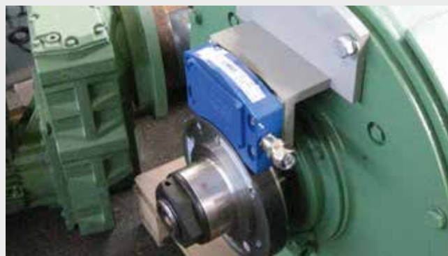
Deutlich längere Lebensdauer des lagerlosen MAG-Systems gegenüber Standard-Drehgebern / The bearing-free MAG system has a longer service life than standard encoders
