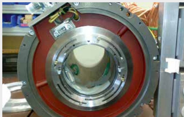
Nachher: Präzise Signale durch Direktanbau des maßgeschneiderten MAG-Systems im Motorengehäuse / After: Precise signals through direct mounting of the customized MAG system in the motor housing
