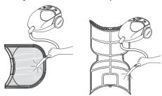
3 Si le filtre est très sale ou bouché par un produit assouplissant, lavez le filtre à charpie dans une solution d'eau chaude savonneuse, puis laissez-le sécher complètement avant de le réinstaller.
