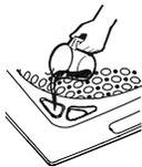
Lorsque le voyant **Tank Low** (réservoir bas) ou **Tank Empty** (réservoir vide) est allumé, plus de détergent doit être ajouté au réservoir pour assurer la disponibilité de détergent pour le prochain cycle.
