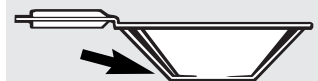
Utilisez des woks à fond plat sur la surface de cuisson en verre.
