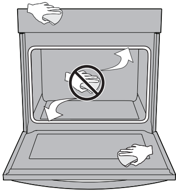
Figure 13: Nettoyer le pourtour du joint de la porte du four
