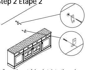
1. Screw the metal bracket into the anchor of wall. Visser la première fixation en métal à l'intérieur de l'ancrage de mur.
