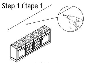
1. Find spot on wall 1" below the top of item. Placer sur le mur à 1 pouce au-dessus de l'article.
