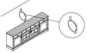
1. Insert strap thru the bracket attached to wall and the second attached to the product. Insérer la sangle à l'intérieur de la fixation en métal. Elle s'attache facilement sur l'arrière du meuble. l'autre bout étant fixé au mur.
