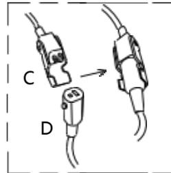
2. Trouvez le cordon d'alimentation C fixé au bas du dossier et connectez-le à la prise D située à l'arrière du siège.
