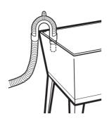
**3** Utilisez la sangle d'attache fournie pour fixer le tuyau de vidange en place.
