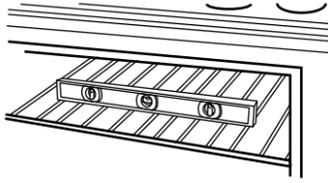
3. Si la cuisinière n'est pas d'aplomb, la tirer de nouveau pour que le pied de nivellement arrière se dégage de la bride antibasculement.
