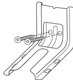
5. À l'aide du tournevis Phillips, monter la bride antibasculement sur le mur ou sur le plancher avec les deux vis n° 12 x  $1\frac{5}{8}$ " fournies.
