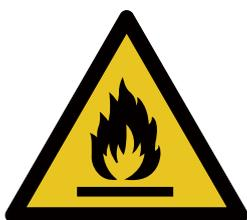
**DANGER** Risque d'incendie ou d'explosion. Frigorigène inflammable utilisé. La réparation sera faite seulement par un personnel qualifié. Utiliser seulement des pièces de rechange autorisées par le fabricant. Tout équipement de réparation utilisé doit être conçu pour les frigorigènes inflammables. Suivre toutes les instructions de réparation du fabricant. Ne pas perforer la conduite de frigorigène.
