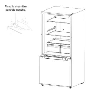
7) Posez verticalement la porte du réfrigérateur sur la charnière centrale, puis sortez la charnière supérieure et le couvercle de l'autre côté du sac d'accessoires, assemblez la charnière supérieure, le couvercle de la charnière et le couvercle du trou.
