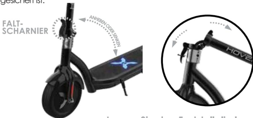
Lassen Sie den Feststellclip los, um die Lenksäule einzuklappen
