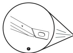
CI2265 LEFT LOWER BRACKET REFORCEMENT BUMPER HAS A TRIANGLE AS SHOWN IN THE DRAW PUT THAT SIDE AT THE LOWER CENTER HOLE OF THE BUMPER
