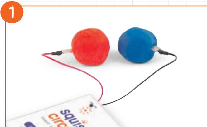
1 Lege 4 AA-Batterien in den Batteriehalter und stelle den Schalter auf "ON". Nimm zwei Stücke leitfähiger Knete und stecke jeweils eine Batterieklemme hinein.
