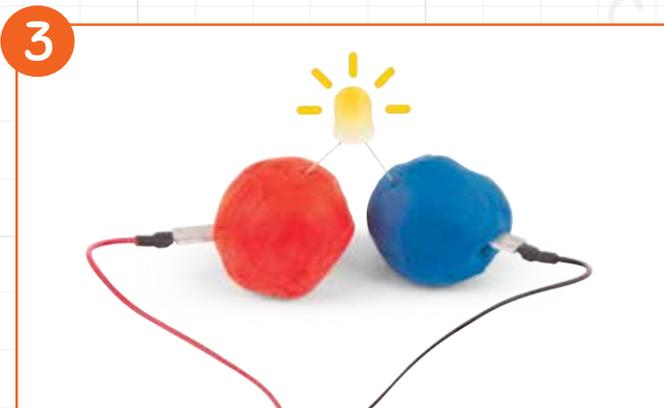
3 Erstelle eine Schaltung, indem du jeden Anschluss der LED in die leitenden Knetstücke steckst. Der längere LED-Anschluss sollte in das Stück Knete mit dem roten Batteriepack-Kabel gehen.
