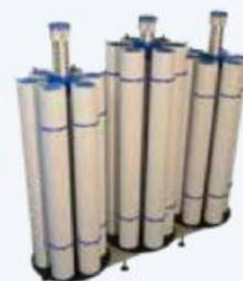
**Podium 3 módulos (+ 18 splitters)** 36 bobinas hasta 62 cm ancho máximo
