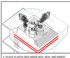
2 PLACE PLASTIC BAG INSIDE BOX, SEAL AND INSERT INNER PACKAGING SURROUNDED BY MINIMUM OF 25MM OF VERMICULITE IN ALL DIRECTIONS.
