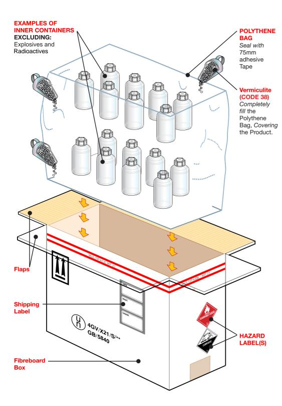
ASSEMBLY DETAILS: FIBREBOARD BOX: 4GV OUTER PACKAGING
