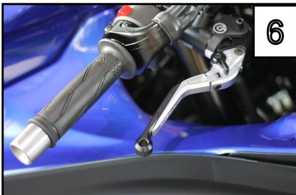
Montieren Sie den MG Biketec Hebel mit der Originalschraube und Mutter wieder am Motorrad (6Nm)
