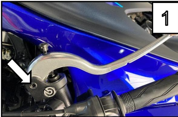
Entfernen Sie die originale Befestigungsschraube indem Sie die Mutter an der Unterseite abdrehen und anschließend die Schraube herausdrehen
