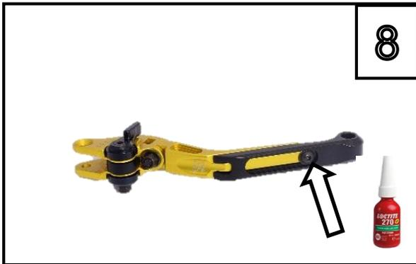
Achtung: Das schwarze Endstück des Hebels muss immer montiert sein. Falls es verstellt wird, verwenden Sie Schraubensicherung (z.B. Loctite 270) und fixieren die Schraube mit 3 Nm.
