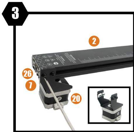
Préparez les **4 vis** en les passant dans le **support du moteur** et ajouter **un écrou** à chaque vis. Insérez les écrous dans les profils de l'axe Y.
