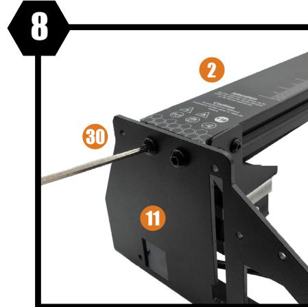
Nehmen Sie den **Fuß** und **befestigen Sie** ihn mit den Schrauben auf der anderen Seite der **Y-Achse**.
