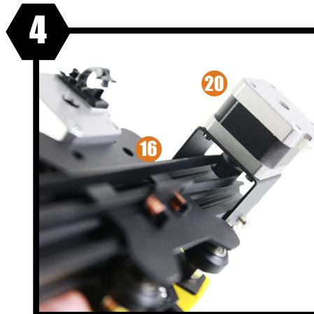
Passez **la courroie** à travers la roue de synchronisation de l'axe Y et **du moteur** mis en place à l'étape précédente.
