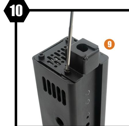
Schrauben Sie die **2 Schrauben** über dem **Laserkopf** ab.
