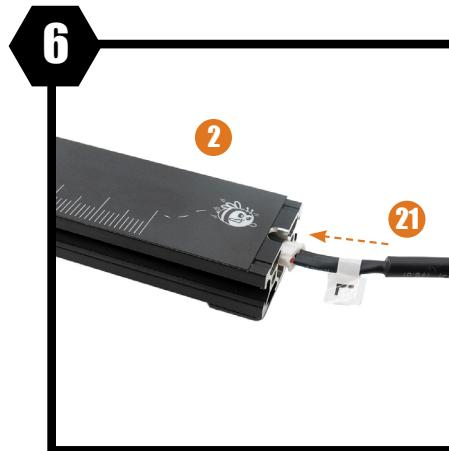
Prenez **le câble d'alimentation de la tête laser** et prenez l'extrémité avec l'étiquette 'L' et passez le dans l'axe Y sur le coté où il y a la petite abeille.
