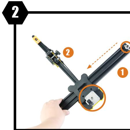
Faites glisser le profilé de l'axe Y à travers les roues de guidage de l'axe X.
