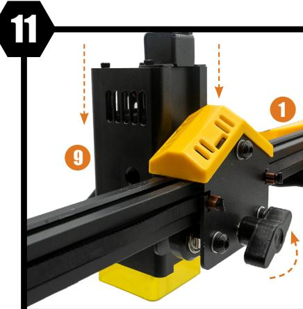
Lösen Sie die Schraube auf der Rückseite der Plattform auf der **X-Achse**.
