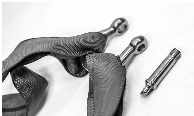
3. Insérez l'axe de la manille à travers la boucle cousue de la slackline.
