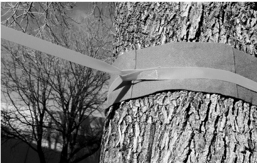
3. Amener le câble principal jusqu'au câble secondaire en assurant qu'il est bien plat sur toute la distance, puis faites-le passer à travers les anneaux en D pour le relier au câble secondaire.
