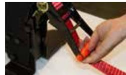
12-13. Si el tensor está en la posición de cierre y tranca, apriete la palanca dentro de la manilla y abra para soltar. Al mismo tiempo de mantener la tensión en la cinta (lograda en el paso 11) con una mano, utilice la otra para darle a la manilla del tensor.
