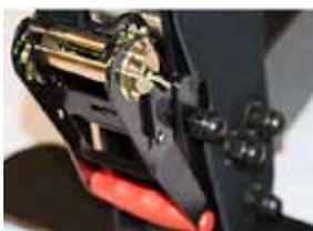
8. Anexe el tensor (A) a los pies (E) del lado opuesto. Alinee los huecos del tensor con los huecos de los pies (E) con la palanca del tensor apuntando hacia abajo. Asegure el tensor con un perno (G2) y tapa de perno (I).
