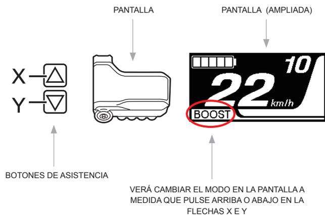
En un lugar seguro y alejado del tráfico, seleccione los diversos modos a medida que pedalee, sintiendo los diferentes grados de asistencia. Puede continuar pedaleando a medida que cambie de modo, y no olvide probar los diversos modos con distintos desarrollos para tener la mejor sensación de su bici.
