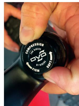
**AJUSTE DE COMPRESIÓN A ALTA Y BAJA VELOCIDAD**
